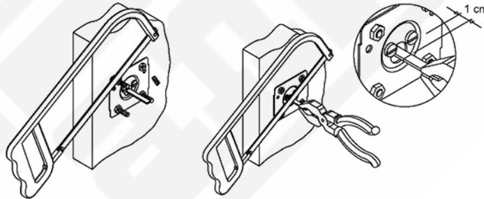
**7** Cortar al ras de las tuercas los pernos de la placa de fijación.
