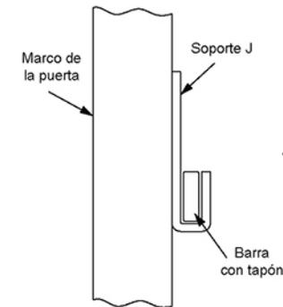
**14** Fijar el soporte J de manera que la barra quede holgada para que se desplace fácilmente.
