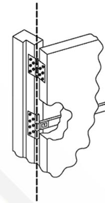
**10** Destajar el marco para colocar la bisagra. **Nota:** El eje de la bisagra debe alinearse con los ejes de las bisagras de la puerta.
