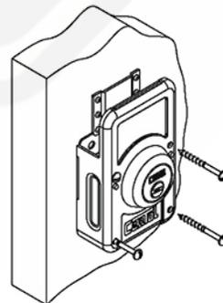
**9** Con sus cuatro tornillos fijar por el lado interior el mecanismo de la tranca.
