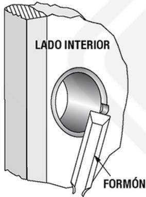
**4** Hacer un bisel para que la placa fijadora del protector se apoye correctamente en la puerta.
