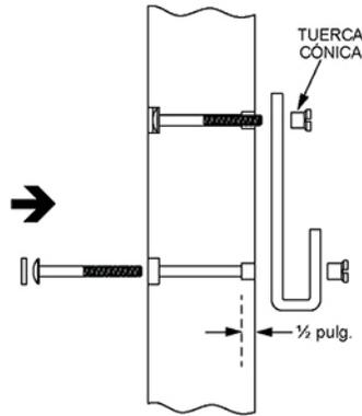
**21** Una vez llegado al tope del trabador del mecanismo de la cerradura, ajustar el perno de la presilla.
