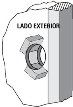
**3** En las puertas contraplacadas colocar dos trozos espaciadores de madera a través del agujero para que la puerta no se comprima. En las puertas macizas no hay que realizar este paso.
