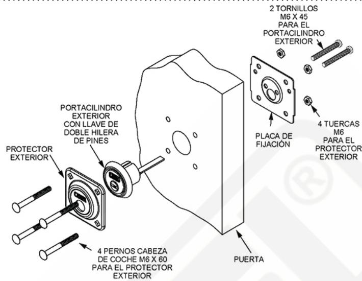
**5** Colocar el portacilindro exterior y fijarlo con sus dos tornillos que a su vez sujetan por dentro la placa de fijación.
