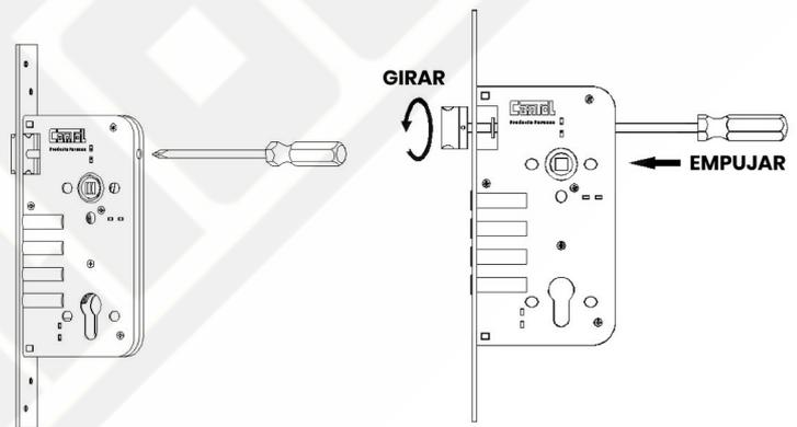
1. Localizar el destornillador tal como se indica en el dibujo hasta que el picaporte quede fuera del frontis.
