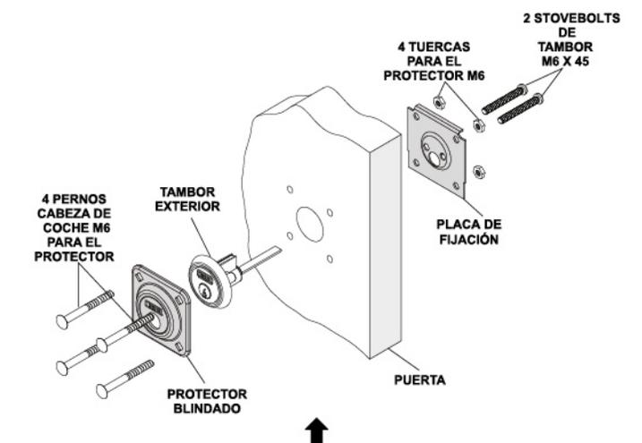
**5** Colocar el tambor a través del agujero de la puerta. Colocar el protector blindado con los 4 pernos, tuernas y la placa de fijación. Fijar los 2 stovebolts del tambor interior como se muestra en la imagen.
