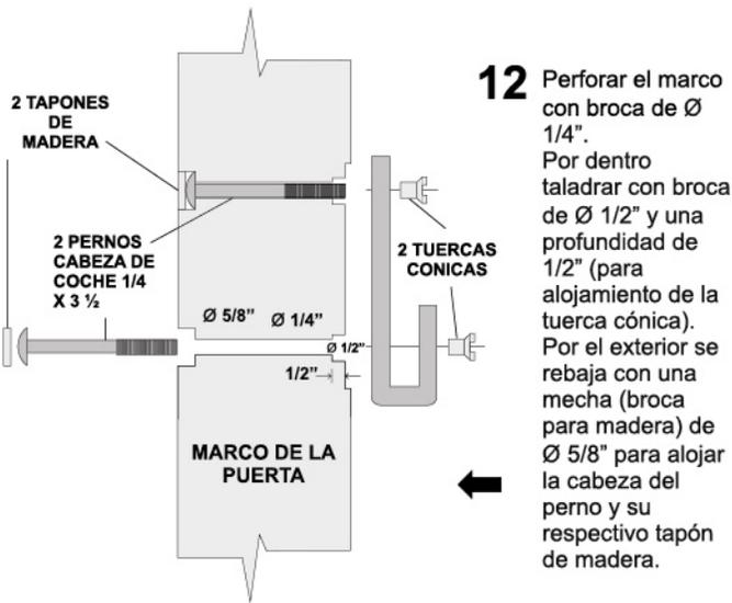
**12** Perforar el marco con broca de  $\varnothing$  1/4". Por dentro taladrar con broca de  $\varnothing$  1/2" y una profundidad de 1/2" (para alojamiento de la tuerca cónica). Por el exterior se rebaja con una mecha (broca para madera) de  $\varnothing$  5/8" para alojar la cabeza del perno y su respectivo tapón de madera.
