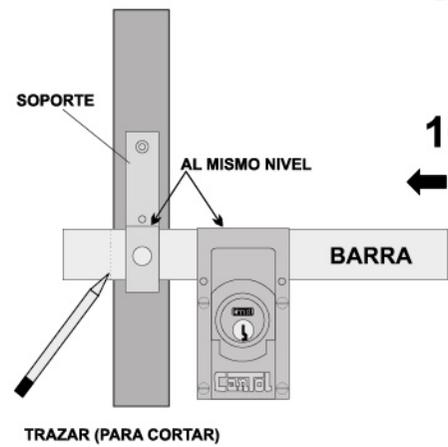
**10** Fijar el Soporte a la misma altura que la cerradura. Cortar la barra cerca al soporte.
