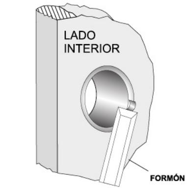
**4** Por el lado interno hágase un "bisel" de modo que la cerradura se apoye totalmente.
