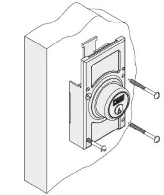
**9** "Destajar" el marco para colocar la bisagra de la tranca; es necesario que el eje de bisagra de la tranca coincida con el resto de bisagras de la puerta.
